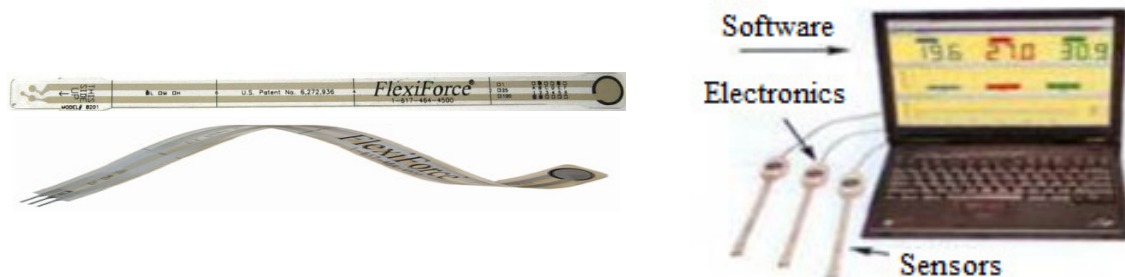
Fig. 3. Flexi Force Tekscan type W-B201-L
